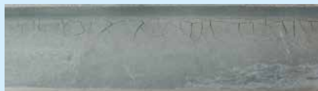
Цинк-эпоксидное покрытие без технологии Avantguard
