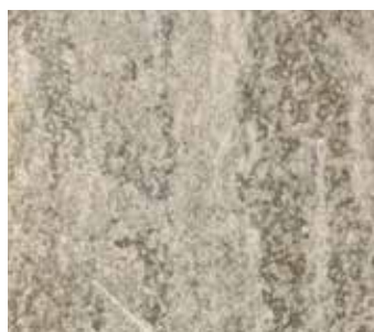
Цинк-эпоксидное покрытие с технологией Avantguard (986 часов)
