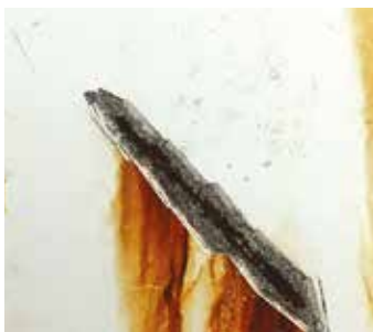
Система покрытий без технологии Avantguard (1440 часов)
