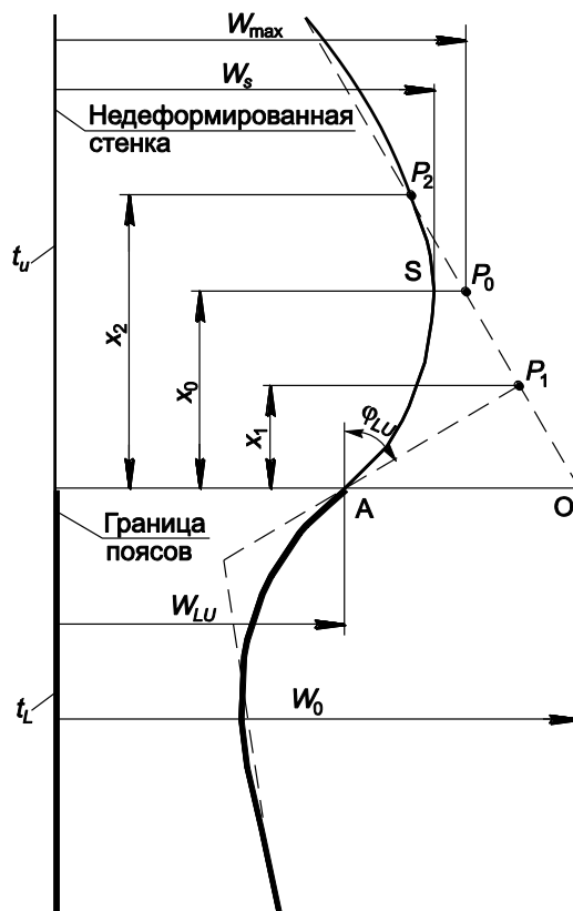
Рисунок 5.2 — Деформации стенки на границе поясов
