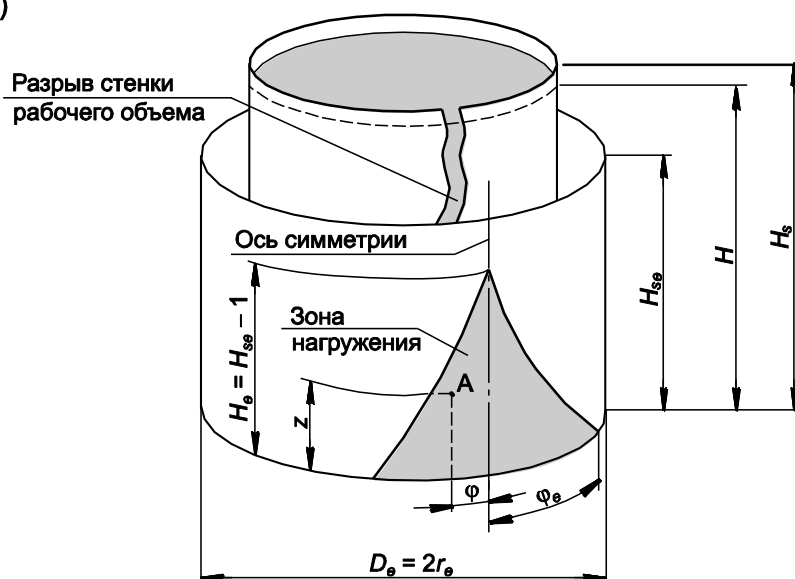
Рисунок 5.7, лист 1 — Схема приложения нагрузки к защитной стенке резервуара и ее фундаменту в условиях аварии:
