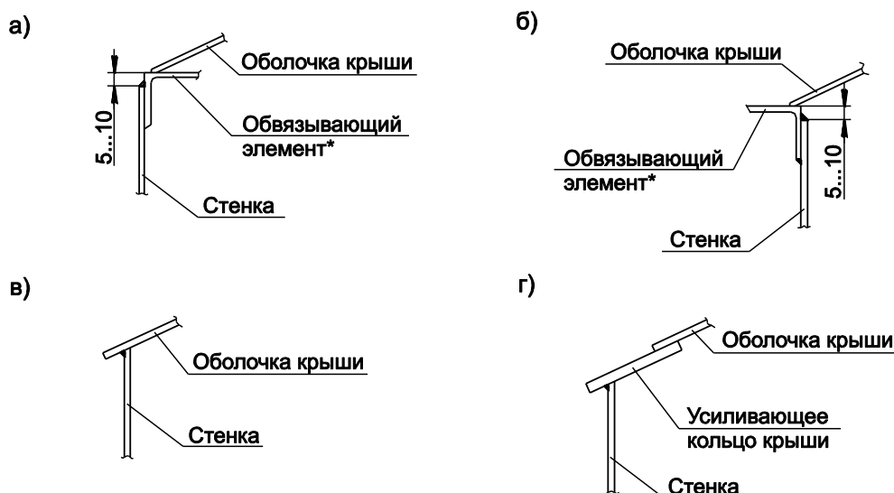
Рисунок 6.2 — Узлы соединения самонесущих конических и купольных крыш со стенкой
